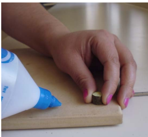
Figura 6. (a) Montaje de la rodaja de coco ( Zanthoxylum coco ) sobre un soporte de madera con cola vinílica. (b) Rodaja de manzano del campo ( Ruprechtia apetala ) pulida.
