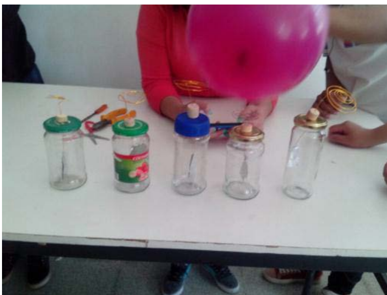
Electroscopio casero, preparados por los alumnos
